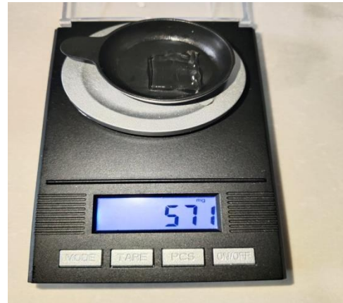
Penimbangan scaffold 70:30:20 pada saat uji swelling
