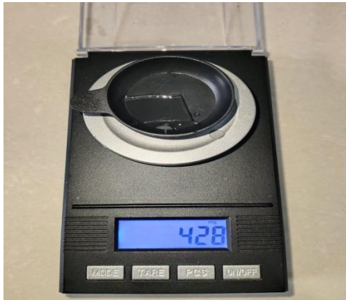
Penimbangan scaffold 60:40:20 pada saat uji swelling
